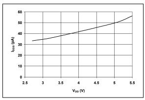
FIGURE 2-36: I<sub>DDS</sub> (Standby) vs. V<sub>DD</sub>.
